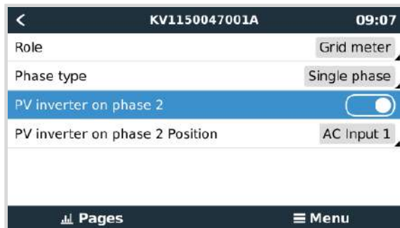
Función dual monofásica para medir la red en L1 y un inversor FV en L2
