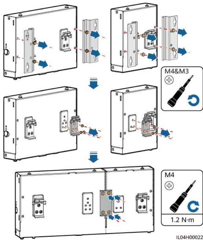
**Paso 2** Instale el SmartLogger y el SmartModule.
