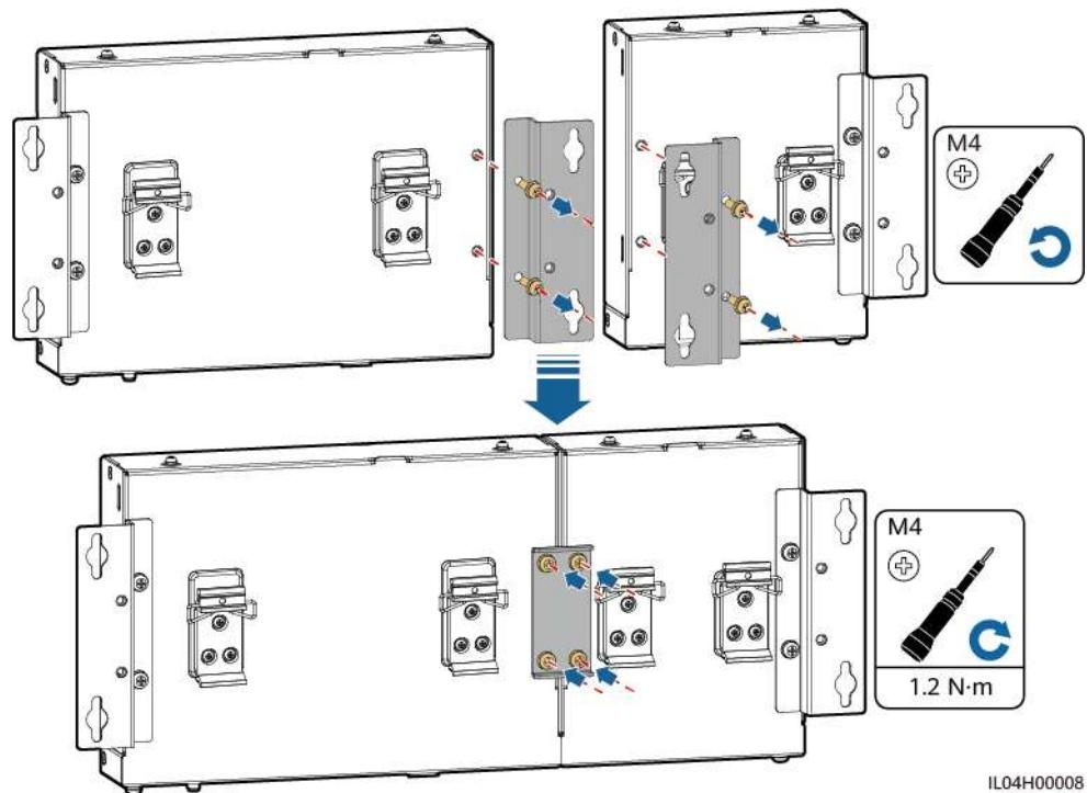
**Paso 2** Instale el SmartLogger y el SmartModule.
