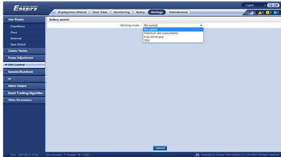
**Tabla 6-16** Modos de funcionamiento del control de almacenamiento de energía
