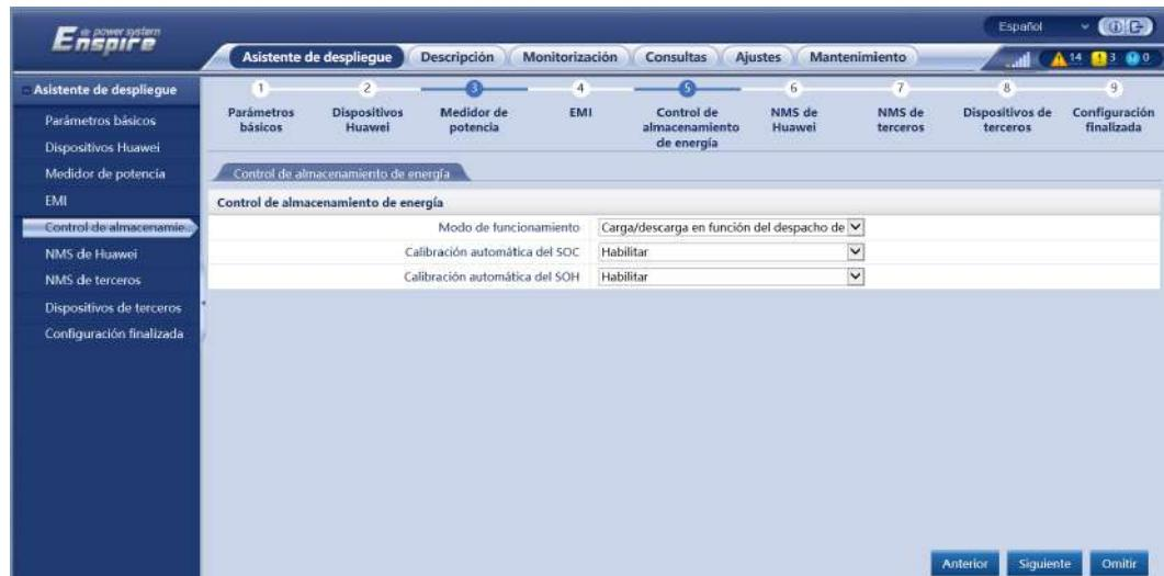
Tabla 6-5 Modos de funcionamiento del control de almacenamiento de energía
