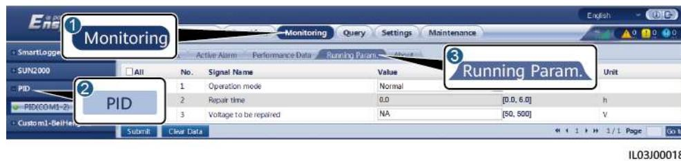
Configure los parámetros de funcionamiento del módulo de PID según el modelo del dispositivo conectado. Los modelos de dispositivos PID incluyen PID01 y SmartPID2000.
