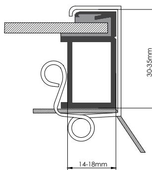
Colocación correcta del producto mediante el clip opcional BBBoxClip (no incluido) para marcos de panel de perfil cerrado; hay dos medidas, de entre las cuales se debe elegir en función de las medidas del marco del módulo:
