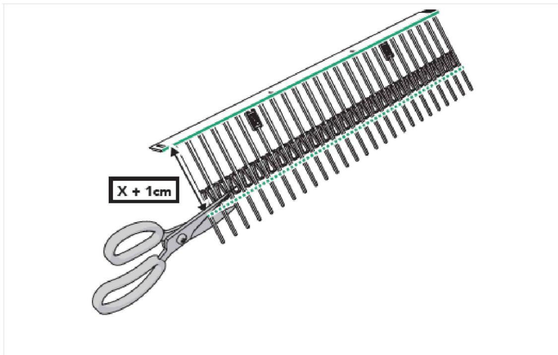
2. Recortar y doblar las tiras para formar las esquinas exteriores e interiores:
