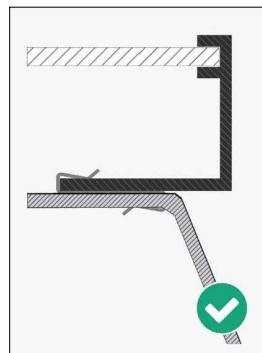
Colocación correcta del producto mediante las pinzas incluidas para marcos de panel de perfil abierto: se debe fijar el BB mediante 8 pinzas por metro, colocando 1 pinza en cada unión de las tiras y 2 pinzas entre uniones
